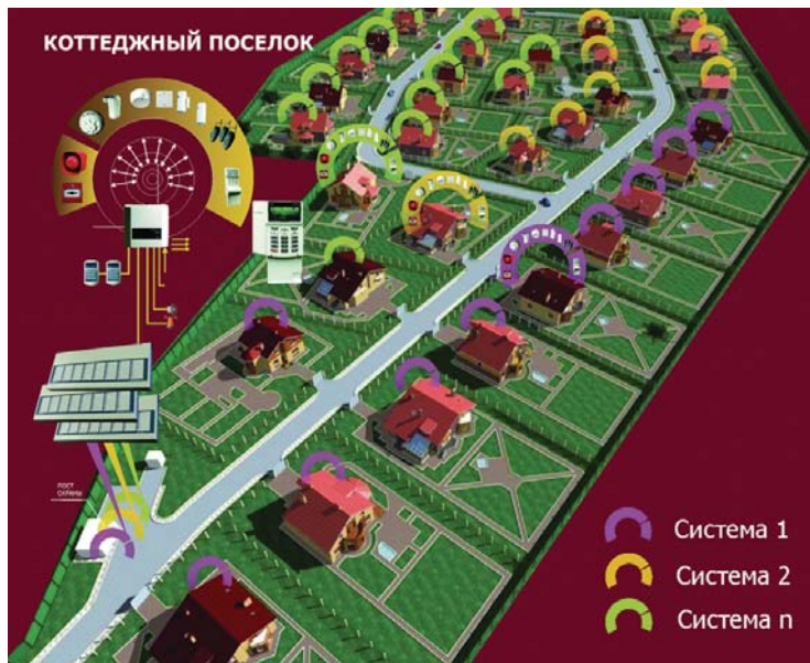
ОПС коттеджного поселка на базе радиосистемы СТРЕЛЕЦ®
