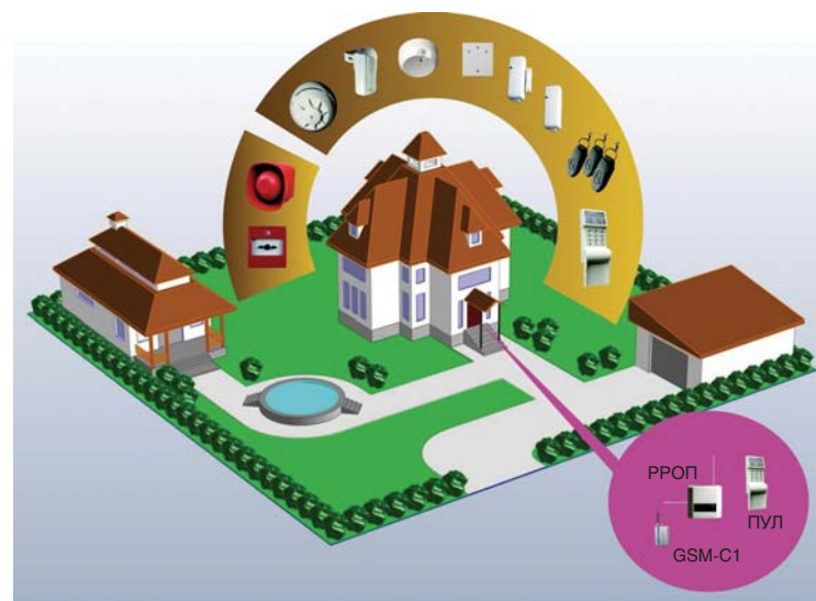
Охрана коттеджа и вспомогательных строений с использованием одного радиорасширителя.
